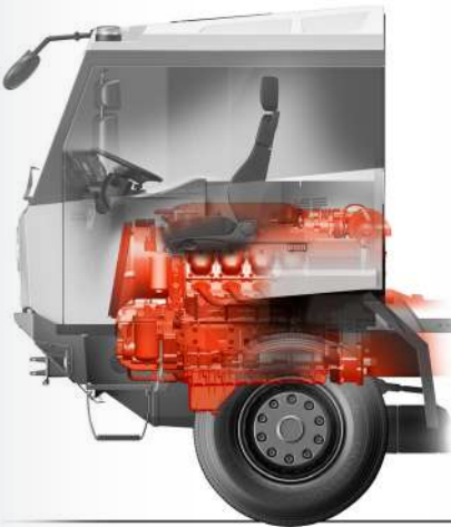
S motorem uloženým nad přední nápravou - FORCE-A (s krytem motoru mezi řidičem a spolujezdcem)
