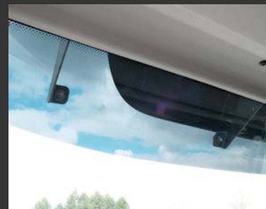
Sluneční clona redukující průnik slunečních paprsků a zamezení přehřívání kabiny.
