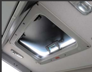
Hliníkový střešní průřez.
